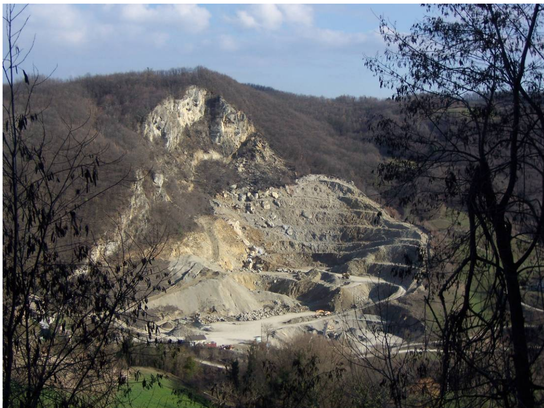
Fotografia 1: panoramica del polo estrattivo dalla strada che da Niviano sale in direzione Lavacchio e Pavullo. Le attività di scavo hanno prodotto una scarpata artificiale, gradonata, sub-parallela alla scarpata di frana in massa che ha interessato la porzione occidentale della montagna di quota 688,8 m e il cui deposito è stato quasi completamente asportato.
