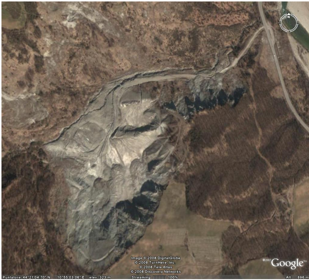
Fotografia 1: immagine satellitare della cava Cantoni. Lungo il confine meridionale sono visibili diverse colate di terra in evoluzione.
