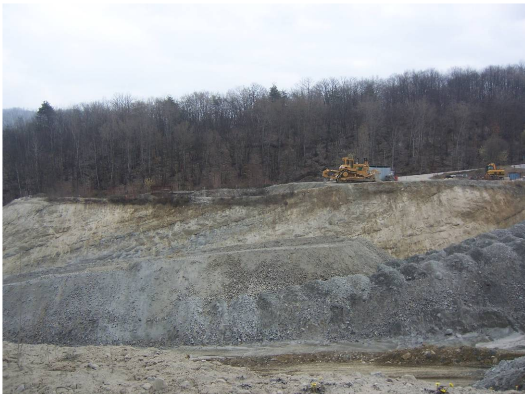
Fotografia 5: settore orientale dell'area di cava. Le arenarie della Formazione di Loiano presentano una non chiara separazione di strati; risulta in ogni caso possibile identificare un assetto degli stessi con immersione media all'incirca 20°E.
