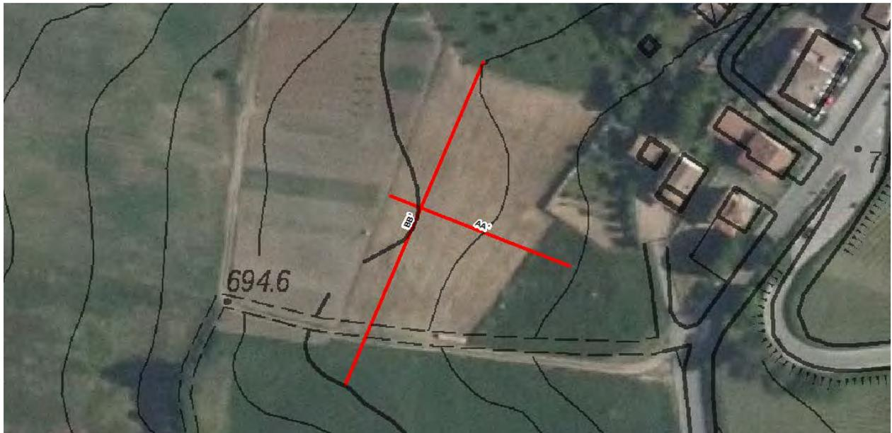
Figura 5.4: Planimetria delle sezioni litostratigrafiche.
