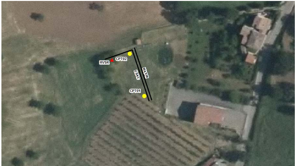
Figura 5.1: Ubicazione delle indagini geognostiche e sismiche.
