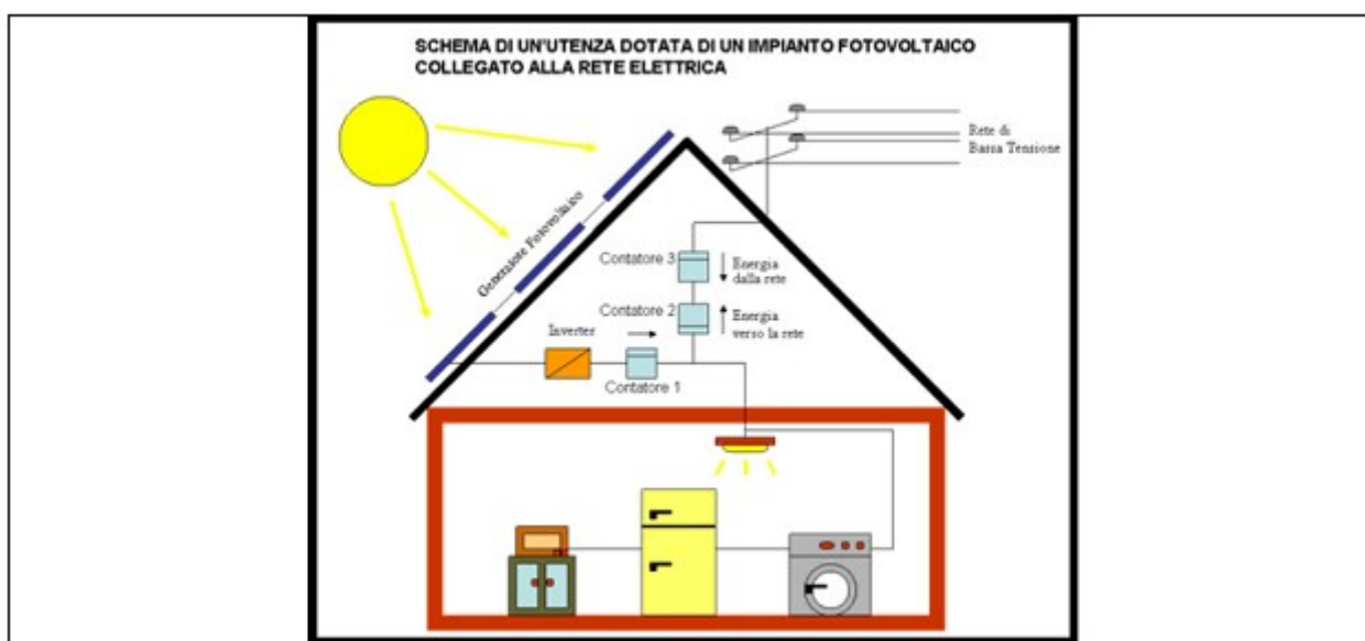
Figura 5 – Principio di funzionamento impianto solare fotovoltaico
