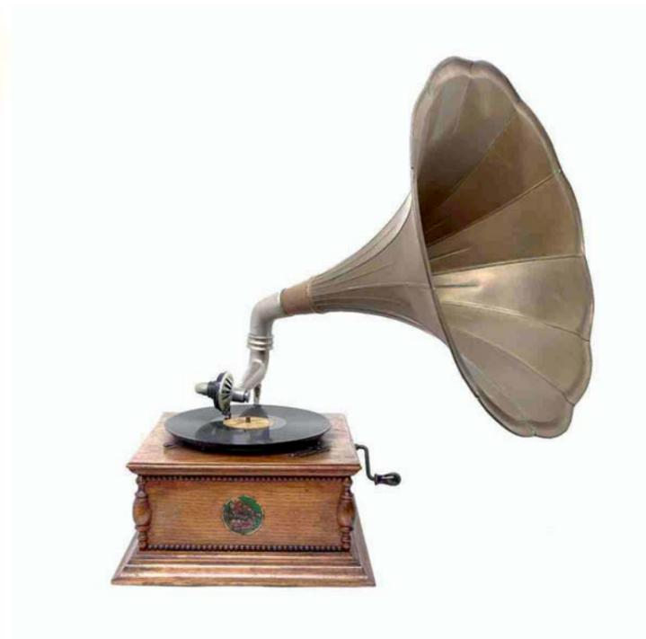
**Grammofofono** è uno strumento in grado di riprodurre meccanicamente il suono, inventato da Emile Berliner nel 1887. A differenza del già esistente fonografo di Edison, che leggeva il suono inciso su dei cilindri, il grammofofono sfruttava le incisioni presenti su un disco (detto disco fonografico). Berliner brevettò per la prima volta il grammofofono negli Stati Uniti nel 1887, dopodiché descrisse ulteriori migliorie in numerosi altri brevetti, fino ai primi anni del XX secolo.
